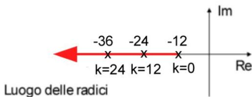
C'è un solo ramo del luogo delle radici (in quanto è uno il polo della FTCA), e tende asintoticamente a meno infinito sull'asse reale (in quanto non ci sono zeri). Dall'espressione del polo della FTCC, si vede che è sempre reale e negativo, pertanto il sistema in ciclo chiuso è stabile e con comportamento non oscillatorio per ogni valore di  $k$ .
