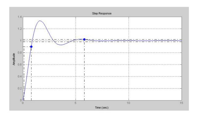
Il grafico sottostante contiene gli andamenti della risposta a gradino di spazio dei sistemi in ciclo chiuso, con i vari tipo di regolatore: analizzare le caratteristiche delle varie curve (transitorio e risposta a regime), in funzione delle proprietà dei vari regolatori.
