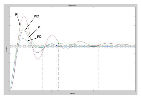
Visualizzare i diagrammi di Bode delle varie funzioni di trasferta in ciclo aperto e associarne le caratteristiche principali (K<sub>p</sub>, MF, pulsazione di taglio, MG) con le forme delle rispettive risposte in ciclo chiuso date nella figura soprastante.
